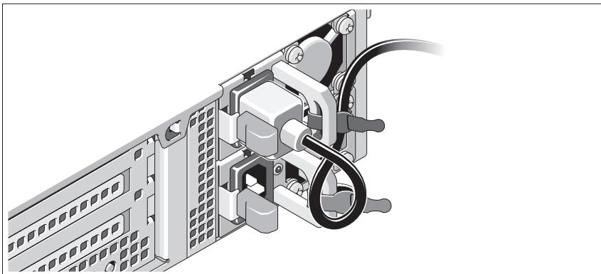
시스템 전원 케이블을 그림에 표시된 대로 루프 모양으로 구부리고 제공된 스트랩을 사용하여 브래킷에 케이블을 고정시킵니다. 전원 케이블의 반대쪽 끝을 접지된 전원 콘센트나, 무정전 전원 공급 장치(UPS) 또는 배전 장치(PDU)와 같은 별도의 전원에 연결합니다.
