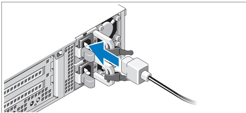
将系统电源电缆连接至系统，如果使用显示器，则将显示器电源电缆连接至显示器。
