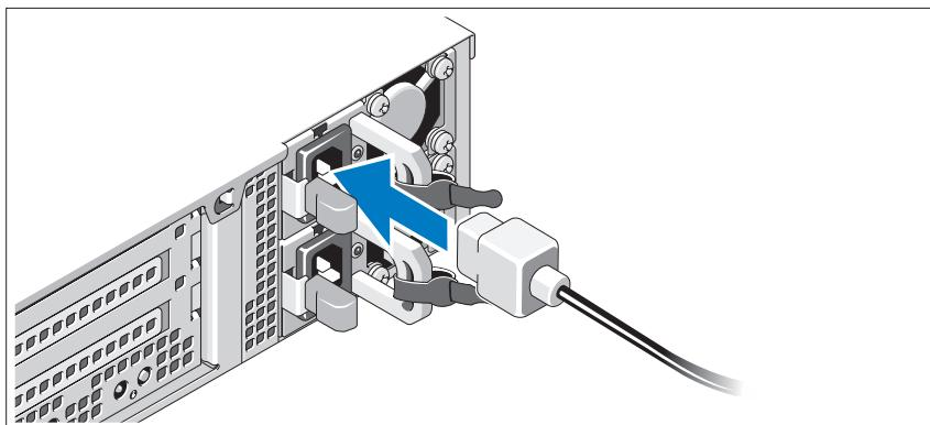
システムの電源ケーブルをシステムに接続し、モニタを使用する場合は、モニタの電源ケーブルをモニタに接続します。
