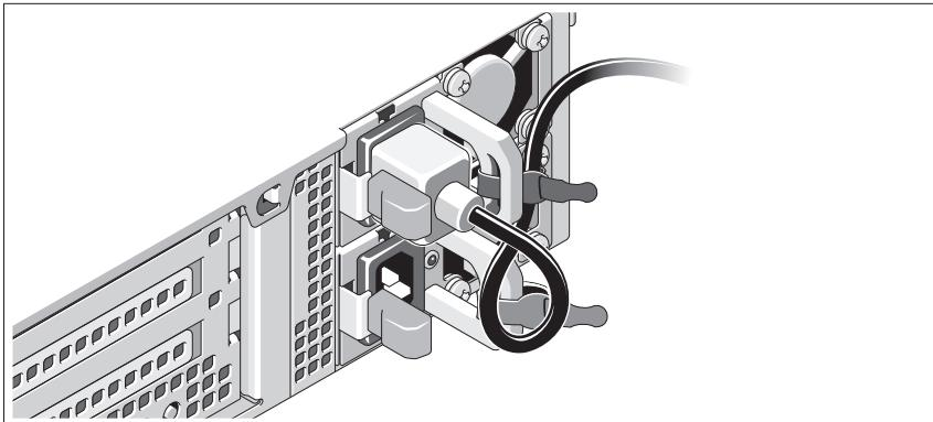
Tekuk kabel daya sistem hingga melingkar seperti terlihat pada gambar dan tahan kabel pada braket menggunakan pengikat yang disediakan. Sambungkan ujung lain kabel daya ke outlet listrik yang telah terhubung ke ground atau ke sumber daya yang terpisah seperti catu daya bebas gangguan (uninterrupted power supply/UPS) atau unit distribusi daya (power distribution unit/PDU).
